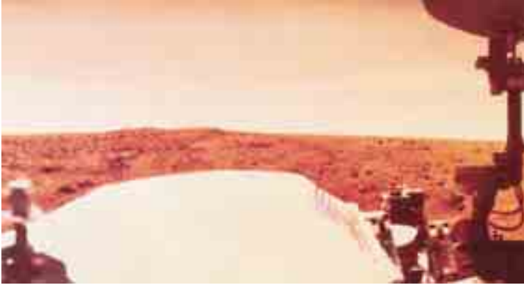
(115) أ. فاينكنج - ١ على المريخ، الهيكل الطويل على اليمين هو ذراع التطويل الذي يدعم هوائي الكسب الذي يعيد البيانات إلى كوكب الأرض ويستقبل منها الأوامر.
